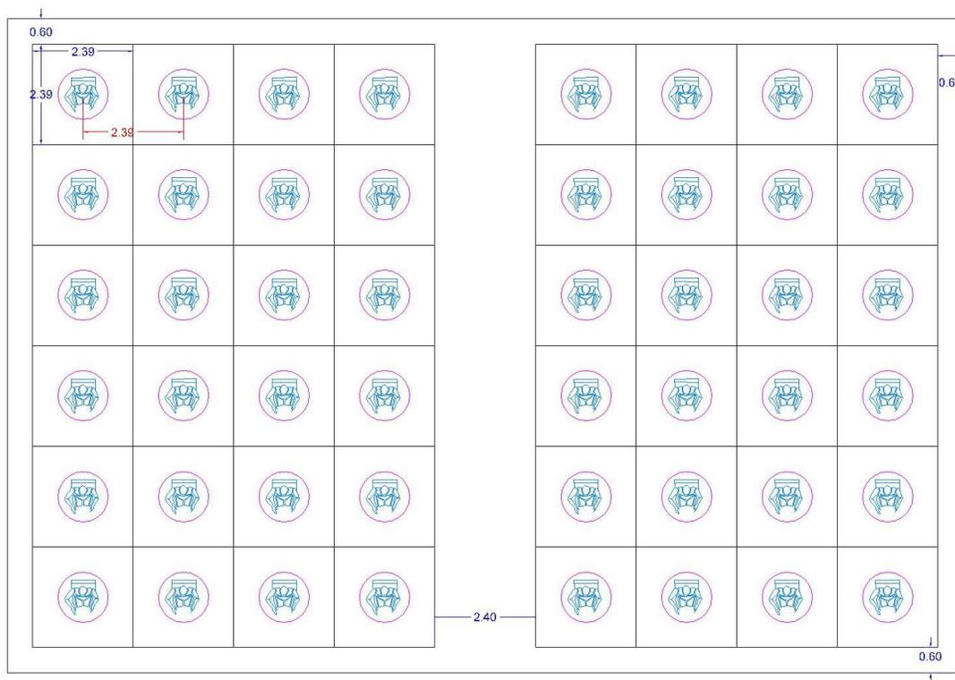
Ilustración 11 Distribución en montaje auditorio, con pasillo de 2.40 m
